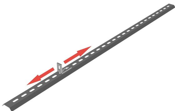
4. placer le crochet en s'assurant que les vis de fixation (non fournies) ont les dimensions minimales de 10 x 100 mm. Il est important de placer deux cavaliers avec joint d'étanchéité, adapté à la tôle et disponible auprès du fabricant, en dessous du crochet. D'une part pour assurer l'étanchéité des vis et pour assurer l'écartement du crochet par rapport à la couverture.
