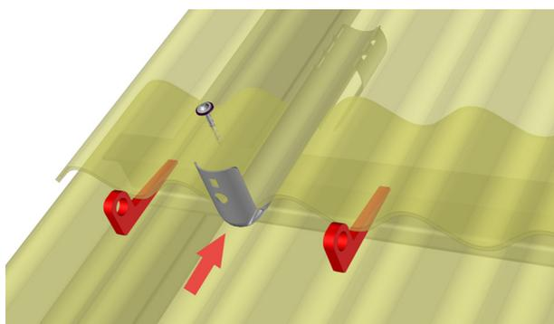
5. tirer le crochet vers le bas pour enclencher les charnières dans la charpente, ôter les deux cales et ensuite resserrer les vis des ondulées.
