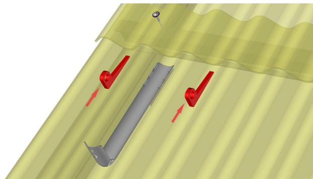
4. glisser le crochet entre les deux plaques ondulées jusqu'en butée pour que la charnière automatique puisse se déployer.
