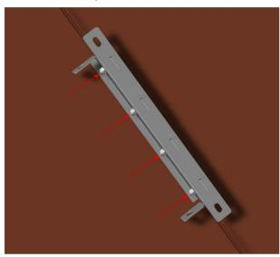
4. **La fixation des EPI** ne peut se faire que sur l'attache **verticale** orientée vers le **bas de la pente. Attention**, seule cette dernière a un effet de freinage et empêchera la chute.
