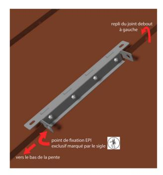
5. <u>La fixation des équipements de sécurité</u> SafeU®Railing RS 11 0120, SafeU®Lifeline RS 15 0200 ou SafeU®Floor RS 14 0140 doit être réalisée conformément aux notices de montage respectives éditées par RMB-BOX.
