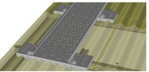
Sur les toiture à joint debout, le support est placé sur deux crochets pour un montage vertical du plancher et sur un crochet pour un montage horizontal. Le plancher est mis en place et fixé par quatre clips SafeU<sup>®</sup>Clip sur les supports.
