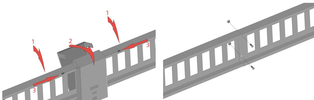
4. Accessoire arrêt glace spécifique aux toitures à joints debout: Clipser l'arrêt glace SafeU®IceStop RS 15 0270 sur la grille neige à l'endroit souhaité et enfoncer les deux languettes à l'aide d'un tournevis pour le verrouiller.
