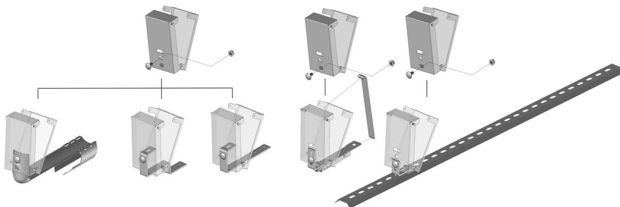
3. Insérer le rail SafeU®Railing dans le boîtier SafeU®Interface, réglez la position, fermez le boîtier et verrouillez le à l'aide des deux vis M5 fournies. Assembler les rails entre eux à l'aide des vis M5 x 12mm et écrous autobloquants fournis.
