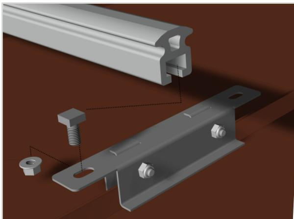
3. Sur tous les autres crochets, on fixera le rail à l'aide du boulon SafeU® Bolt et de la vis M8 avec rondelle à 20 Nm. Cette pièce autorise un glissement du rail et permet de rejeter la dilatation de ce dernier vers les extrémités de l'installation.
