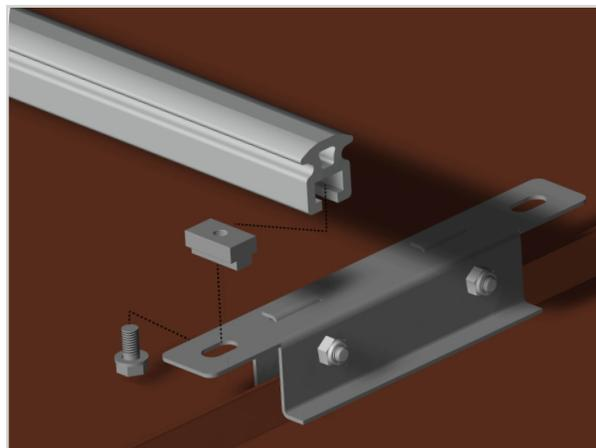
4. Insérer les jonctions et serrer les 4 vis M6 à 16 Nm. Le chariot amovible peut alors être introduit et le système est prêt à l'usage.
