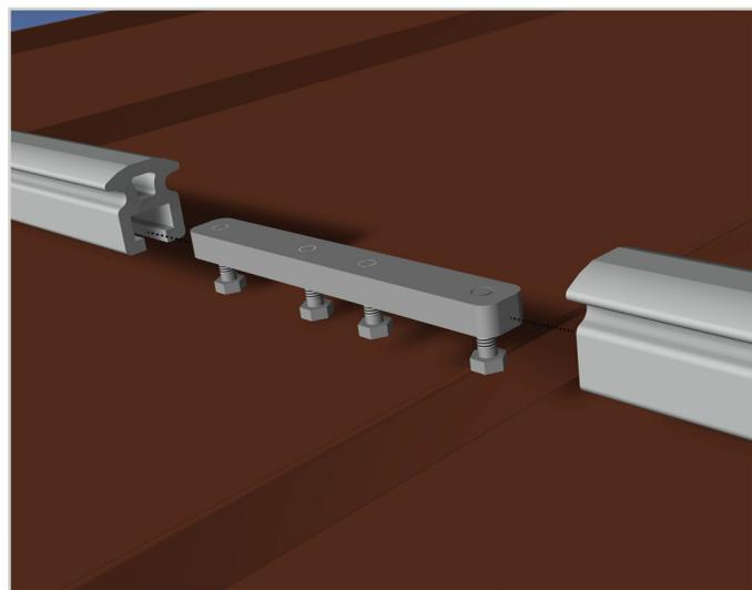
5. Fixer les pièces de verrouillage d'extrémité SafeU®End aux extrémités de rails et serrer les deux vis M6 à 16 Nm. Le chariot amovible peut alors être introduit et le système est prêt à l'usage.
