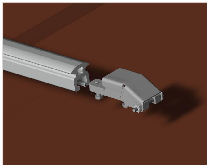
6. Le chariot SafeU®TrolleyH peut être utilisé pour une pente de l'axe central du rail par rapport à l'horizontale allant jusqu'à 2%. Au delà, il est indispensable d'utiliser le chariot avec frein SafeU®TrolleyV.
